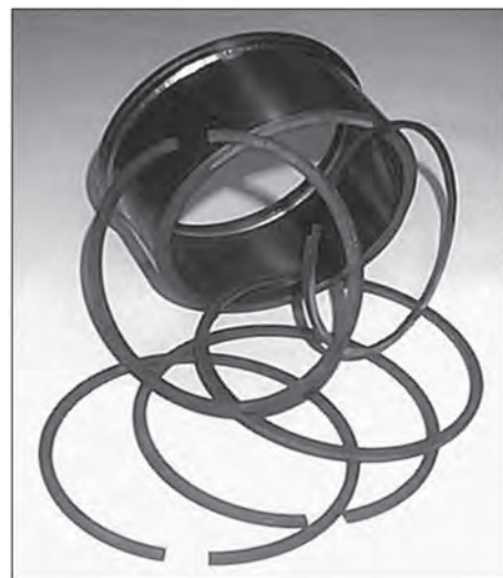
Рис. 17. Штампованные чугунные заготовки и изготовленные из них кольца
