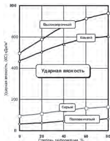
Рис. 9. Зависимость ударной вязкости чугунов от степени деформации
