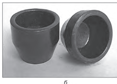
Рис. 14. Получение изделий из чугуна типа втулок горячим выдавливанием: а – инструмент для получения детали «направляющая втулка клапана», исходная заготовка, втулка с трещинами, качественная втулка; б – деталь «корпус сверлильного патрона» из чугуна, полученная выдавливанием за один проход из цельной цилиндрической заготовки
